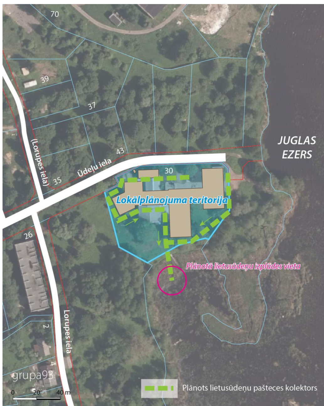
31. attēls. Plānotā lietussūdeņu novadīšanas shēma.
