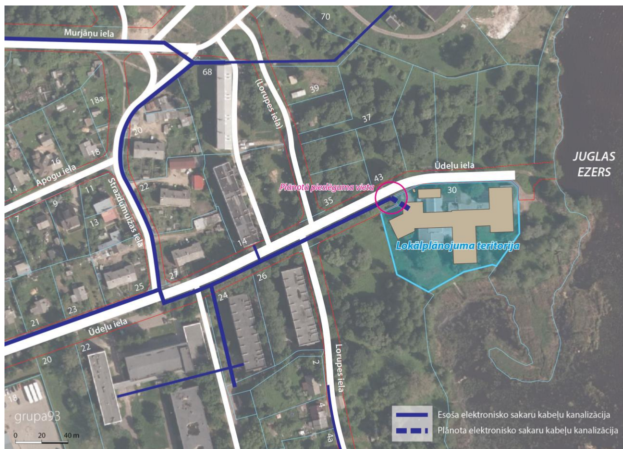
28. attēls. Plānotā elektronisko sakaru apgādes shēma.
