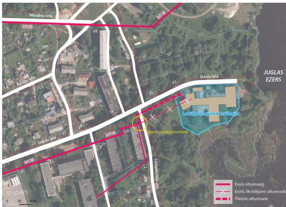
32. attēls. Centralizētās siltumapgādes risinājums.
